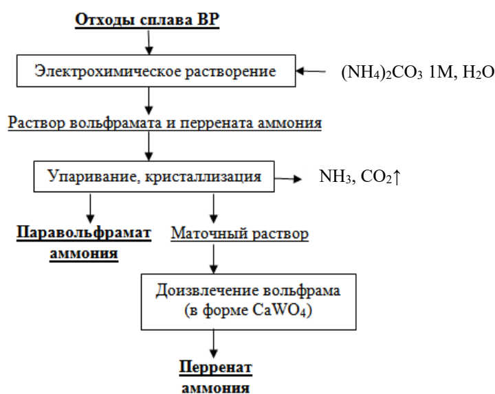
Рис. 2. Принципиальная технологическая схема электрохимической переработки отходов сплава ВР в аммиачно-карбонатных растворах
